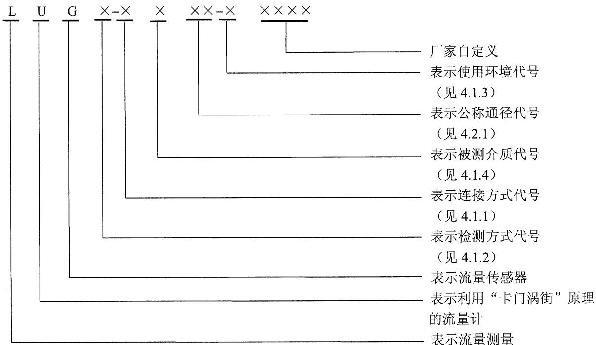
注：根据 JB/T 9236 的规定，LU 表示涡街流量计，LUG 表示涡街流量传感器，LUB 表示涡街流量变送器，LUZ 表示涡街流量转换器。
